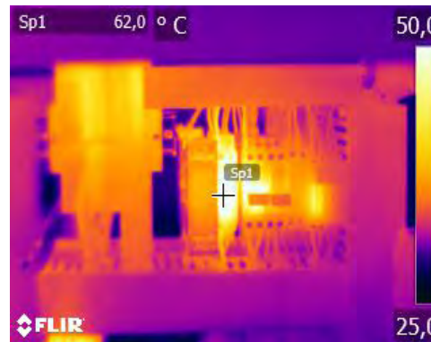
IR und VI eines thermisch auffälligen Installationsschützes von Untersuchung 1.
