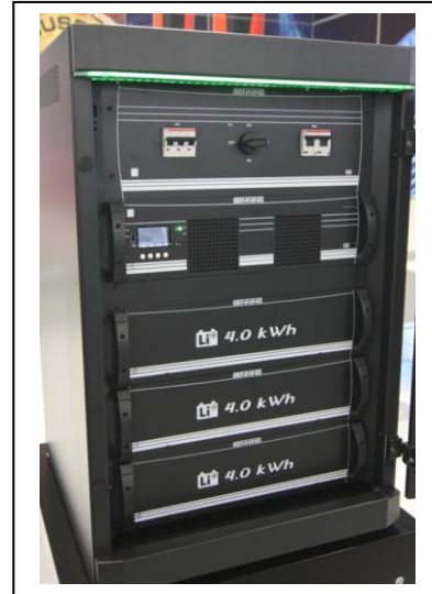
Benning Energie- Speichersystem geöffnet
